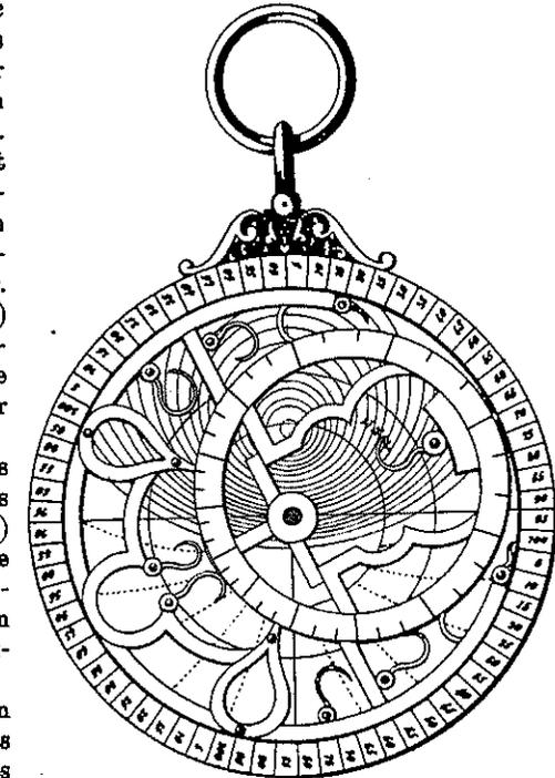
Fig. 1a. Ebenes Astrolab. Vorderseite.
