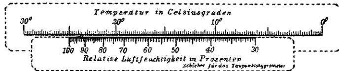
Bild 29. Schieber für das Taupunktthermometer.
