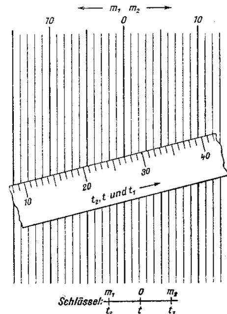
Fig. 2. Drehschieber für die Mischungsformel
