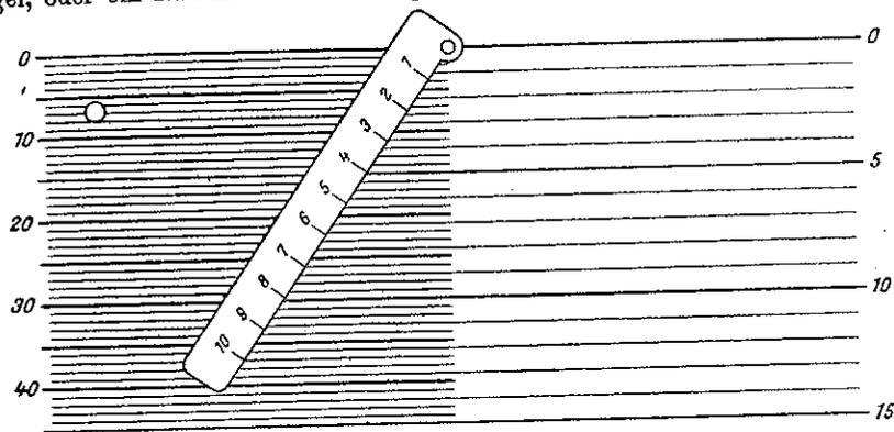
Fig. 1. Dreher zur Berechnung der Proportionalteile beim Logarithmenrechnen. Beispiel: Tafeldifferenz 37, letzte Ziffer des Numerus 7. Stellt man 10 auf 37, so zeigt 7 auf den gesuchten Proportionalteil 26.
