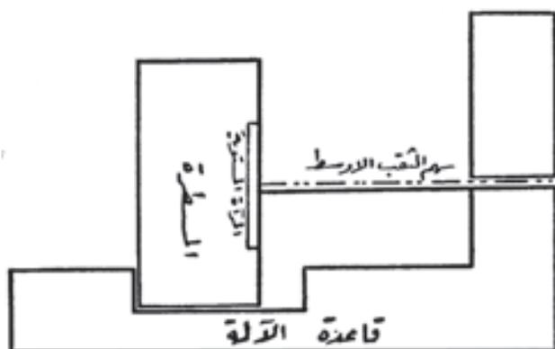
Der zweite Hauptbestandteil ist ein Halbzylinder aus Holz, der fest auf einer runden Holzplatte ruht, wie im Schnitt auf nebenstehender Skizze dargestellt. Ibn al-Haiṭam betont die Notwendigkeit, Holz von sehr guter Qualität zu verwenden.
