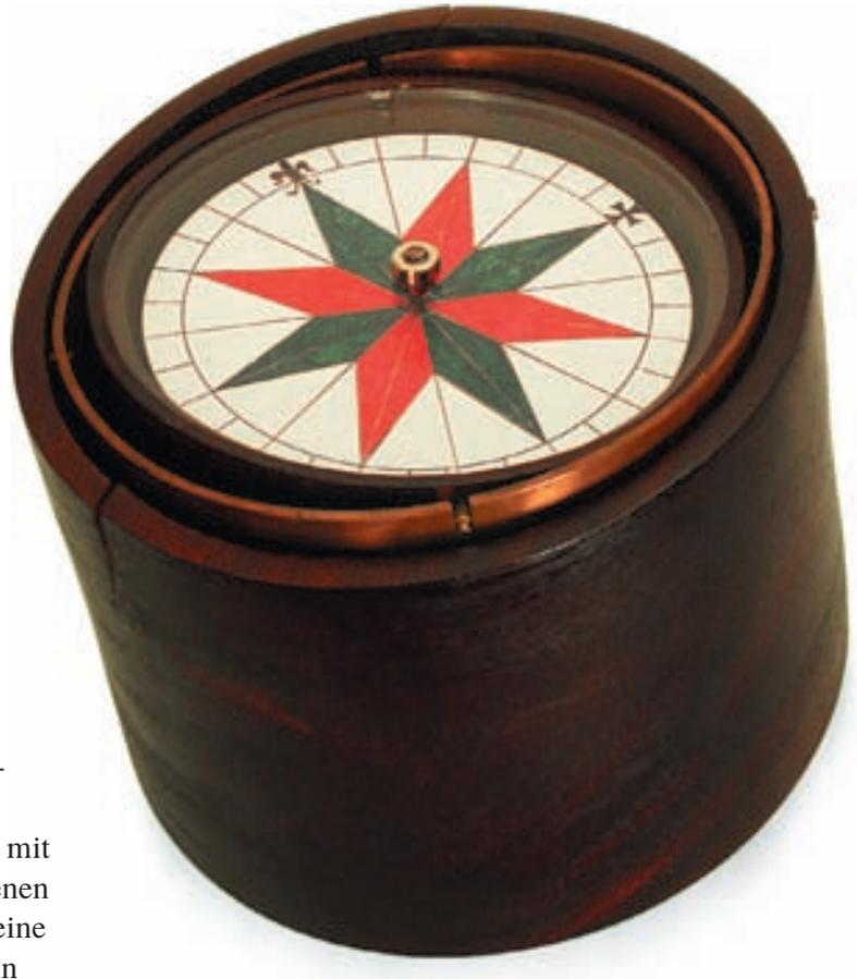
Gedrehter Zylinder aus Hartholz.
