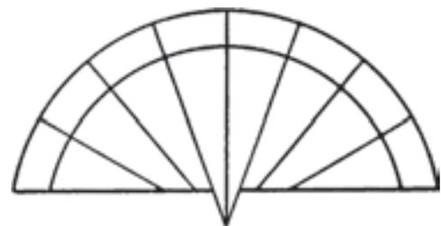
Zum Rande hin werden beidseitig 2 cm breite Segmente entfernt. Die Spitze des übriggebliebenen Dreiecks entspricht dem Mittelpunkt des die Messingplatte bestimmenden Kreises.
