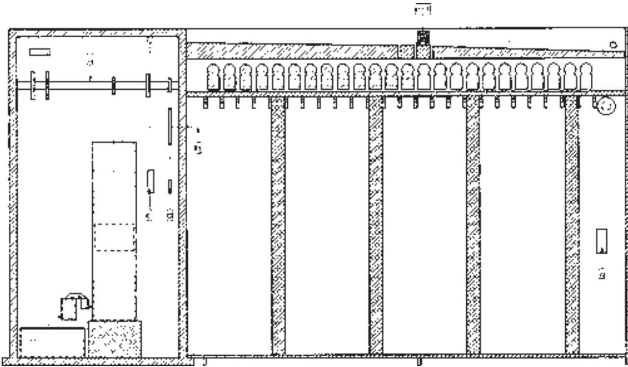
Konstruktionsschema der Wasseruhr aus Fes.
