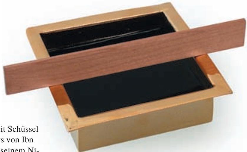
Die dritte Art des Nivellierens, die mit Schüssel und Latte, entspricht etwa dem bereits von Ibn Sīnā vorgeschlagenen Verfahren mit seinem Nivelliergerät (s.o.S. 141). Die Beschaffenheit der Oberfläche, die mittels einer mit Wasser gefüllten Schüssel (*ḡafna*) nivelliert werden soll, prüft Ibn Luyūn mit einer Latte (*qubṭāl*), die auf die Schüssel gelegt wird.
