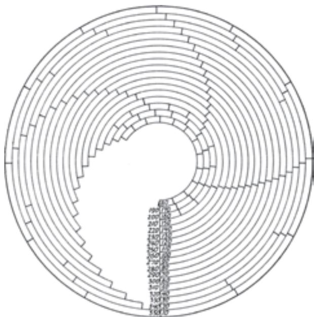
«Diese Figur gibt nach den Angaben des Textes eine Draufsicht auf die Platte der Becheruhr für die <zeitlichen> Stunden. Die Stundeneinteilung wurde nur in einem Teil der Kreise vollständig durchgeführt»
